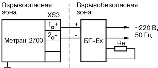
БП-Ex - искробезопасный блок питания с выходным напряжением 24 В.
