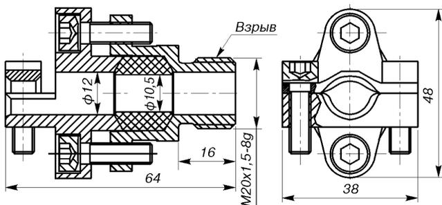
**Кабельный ввод для монтажа бронированного кабеля (БК) <sup>1)</sup>.**
