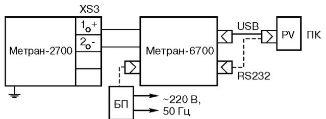
БП - блок питания с выходным напряжением  $(9 \pm 0,5) \text{ В}$ .
