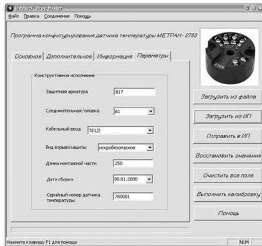
Программа предназначена для конфигурирования и настройки термопреобразователей с унифицированным выходным сигналом Метран-2700, укомплектованных измерительным преобразователем (ИП) Метран-270М.
