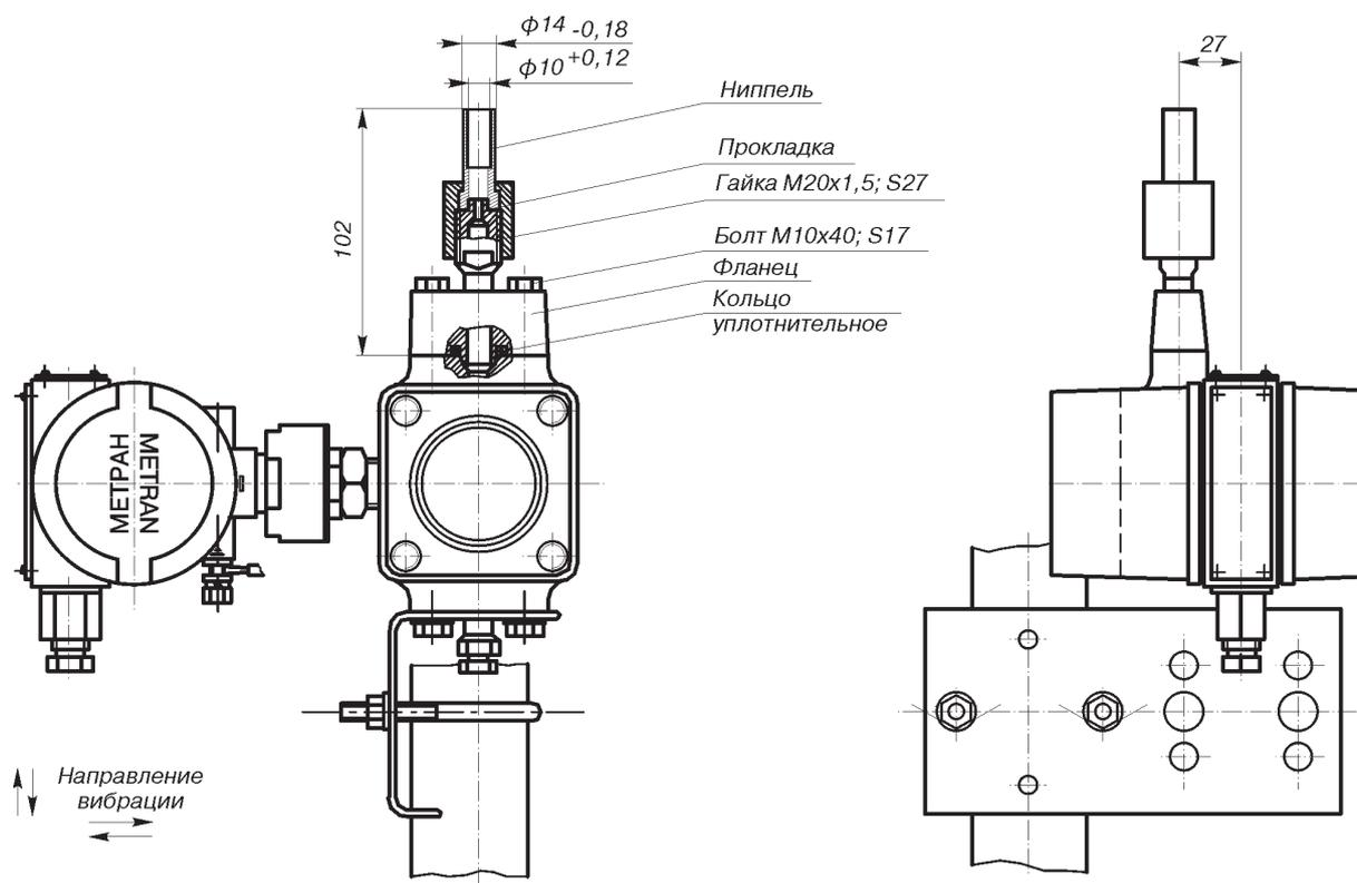
Рис.6. Метран-22-АС-1 МП, МП1 мод.2030, 2040, 2110, 2210, 2310, 2120, 2130, 2140, 2220, 2230, 2240, 2320, 2330, 2340 с установленным ниппелем под накидную гайку М20х1,5 (остальное см.рис.5).
