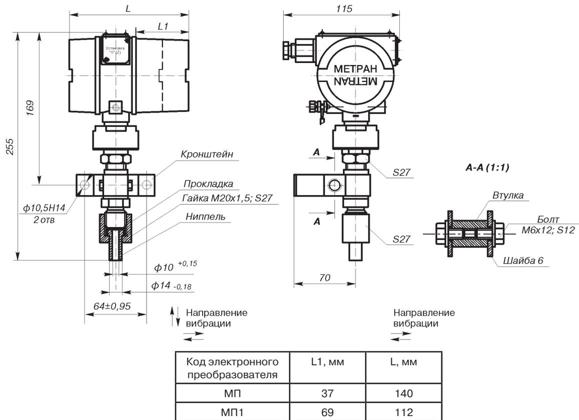
Рис.4. Метран-22-АС-1 МП, МП1 мод.2051, 2061, 2151, 2161, 2171, 2351 с установленным ниппелем.
