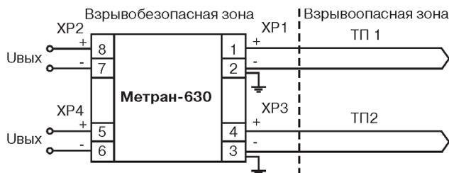
**XP1** - выход ТП1; **XP2** - выход на измерительное устройство;
