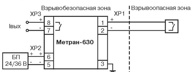
**XP1** - выход взрывозащищенного датчика;
