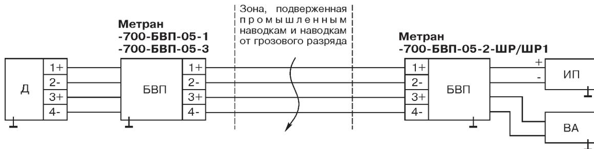
**Рис.3. Защита датчика обыкновенного исполнения, ИП и ВА при 4-х-проводной линии связи с помощью 2-х барьеров.**
