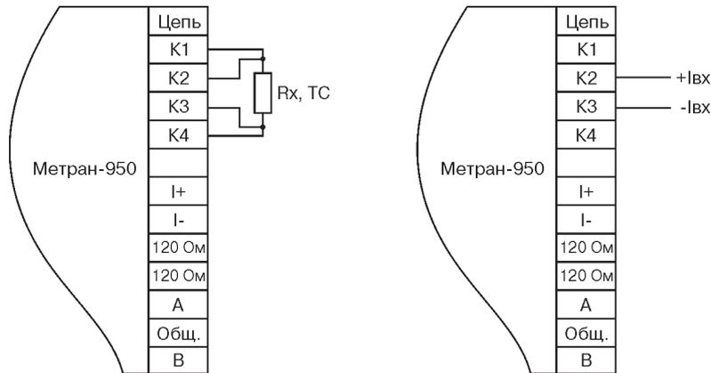
Подключение TC по 4-х-проводной схеме.
