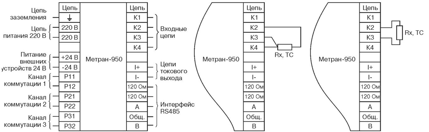
Подключение TC по 3-х-проводной схеме.
